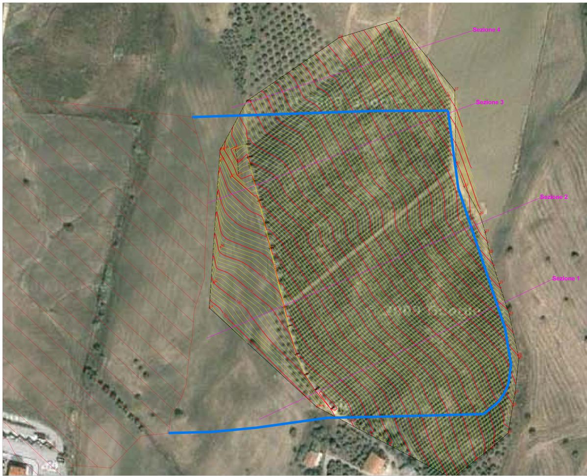
Rilievo topografico sull'area di ampliamento.
