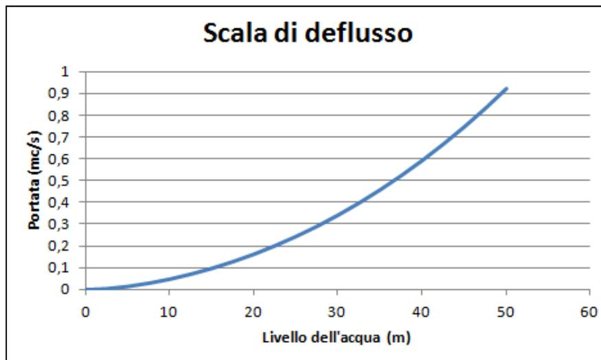
Fig. 11 – Scala di deflusso per la canaletta in terra
