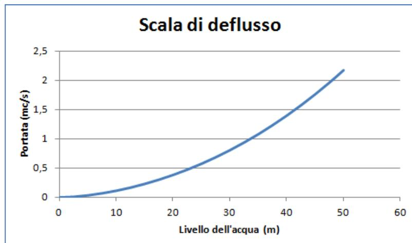
Fig. 9 – Scala di deflusso per la canaletta in materassino di tipo Reno.
