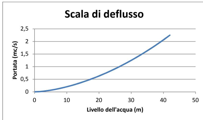
Fig. 4 - Scala di deflusso per la canaletta in c.l.s. in sezione trapezoidale
