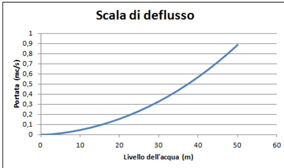
Fig. 10– Scala di deflusso per la canaletta in terra
