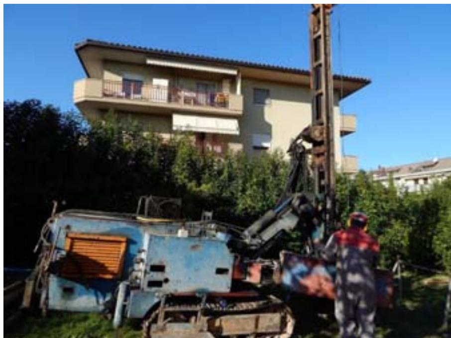
*Figura 18: Sonda MK 420 D1 della C.M.V. SpA utilizzata per il carotaggio.*
