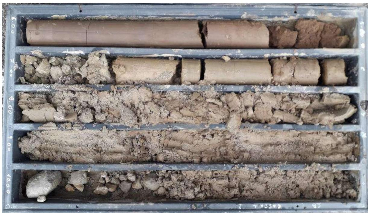
Foto 13 – Cassetta del sondaggio S3 da 6,0 a 10,0 m dal p.c.
