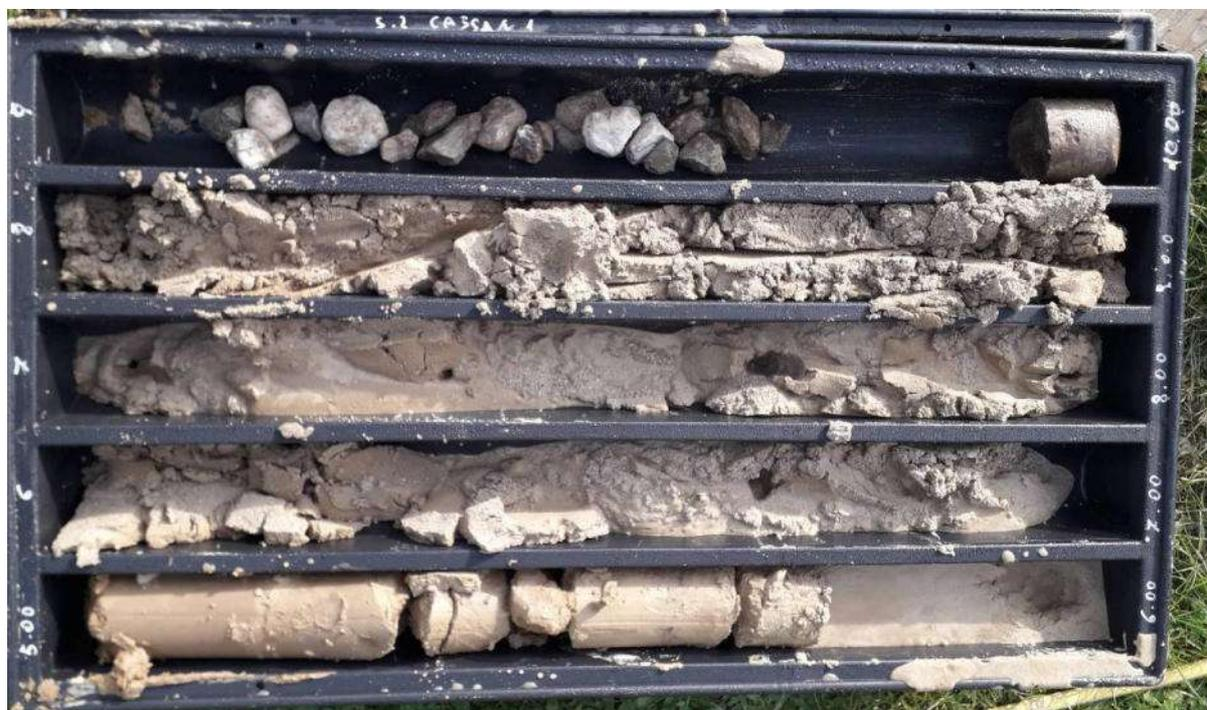
Foto 9 – Cassetta del sondaggio S2 da 6,0 a 10,0 m dal p.c.
