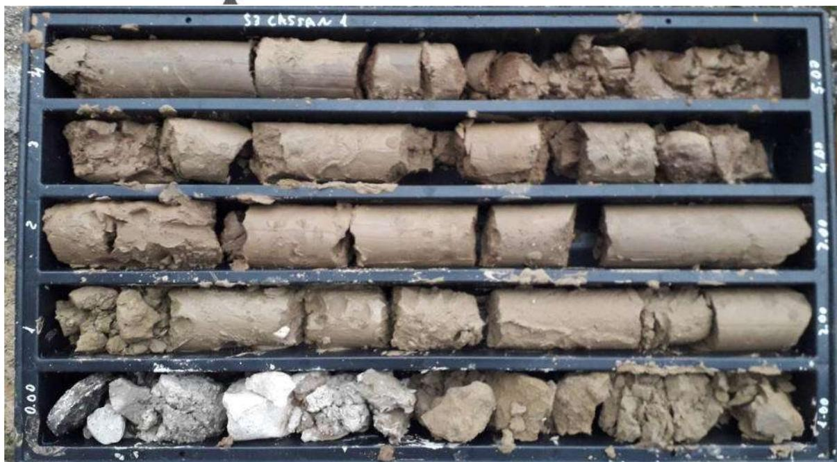
Foto 12 – Cassetta del sondaggio S3 da 00,0 a 6,0 m dal p.c.
