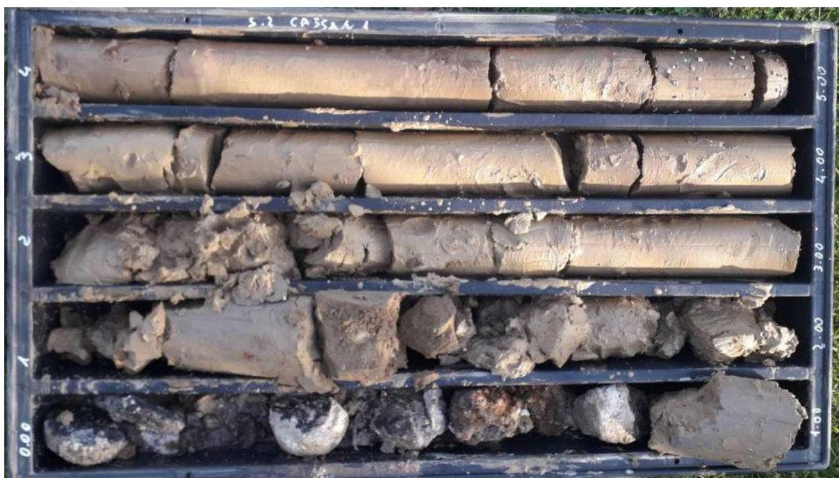
Foto 8 – Cassetta del sondaggio S2 da 0,0 a 6,0 m dal p.c.
