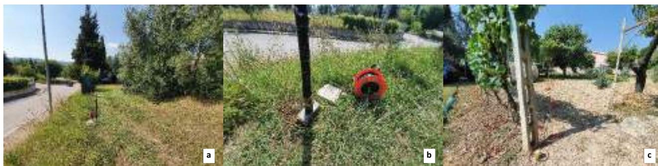
Foto 3 – sequenza fotografica indagine MASW: a.posizione dello sparo visto da Nord; b.particolare sulla punto di sparo cion posizionamento del geofono starter; c.panoramica da Nord-Est sull'allineamento di geofoni realizzato.
