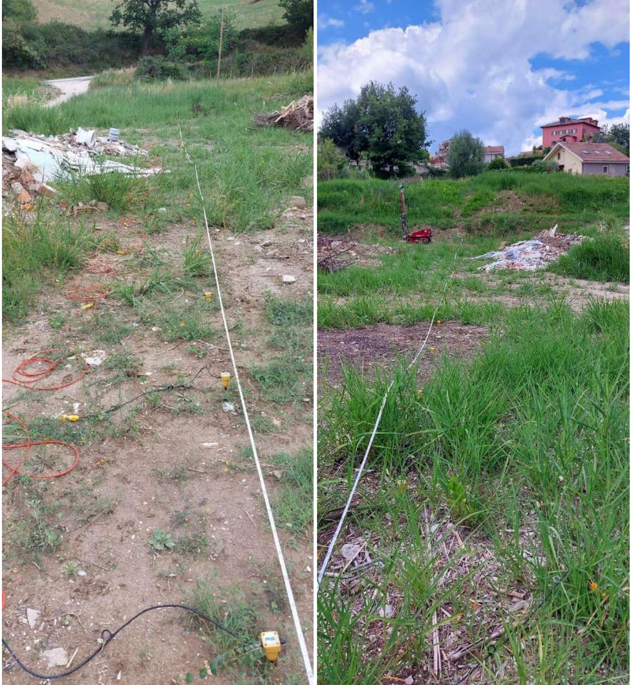
*Foto 8: stendimento sismico per indagine tipo MASW.*
