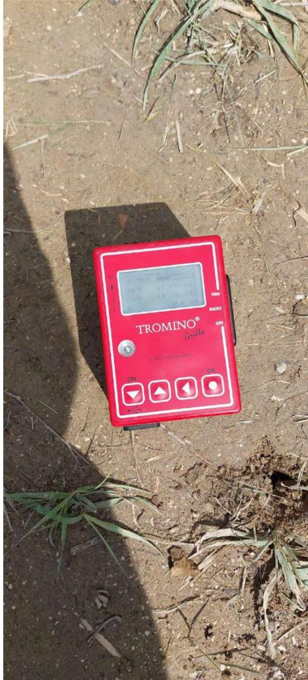
*Figura 13 Tromografo in fase di registrazione (HVS-1)*
