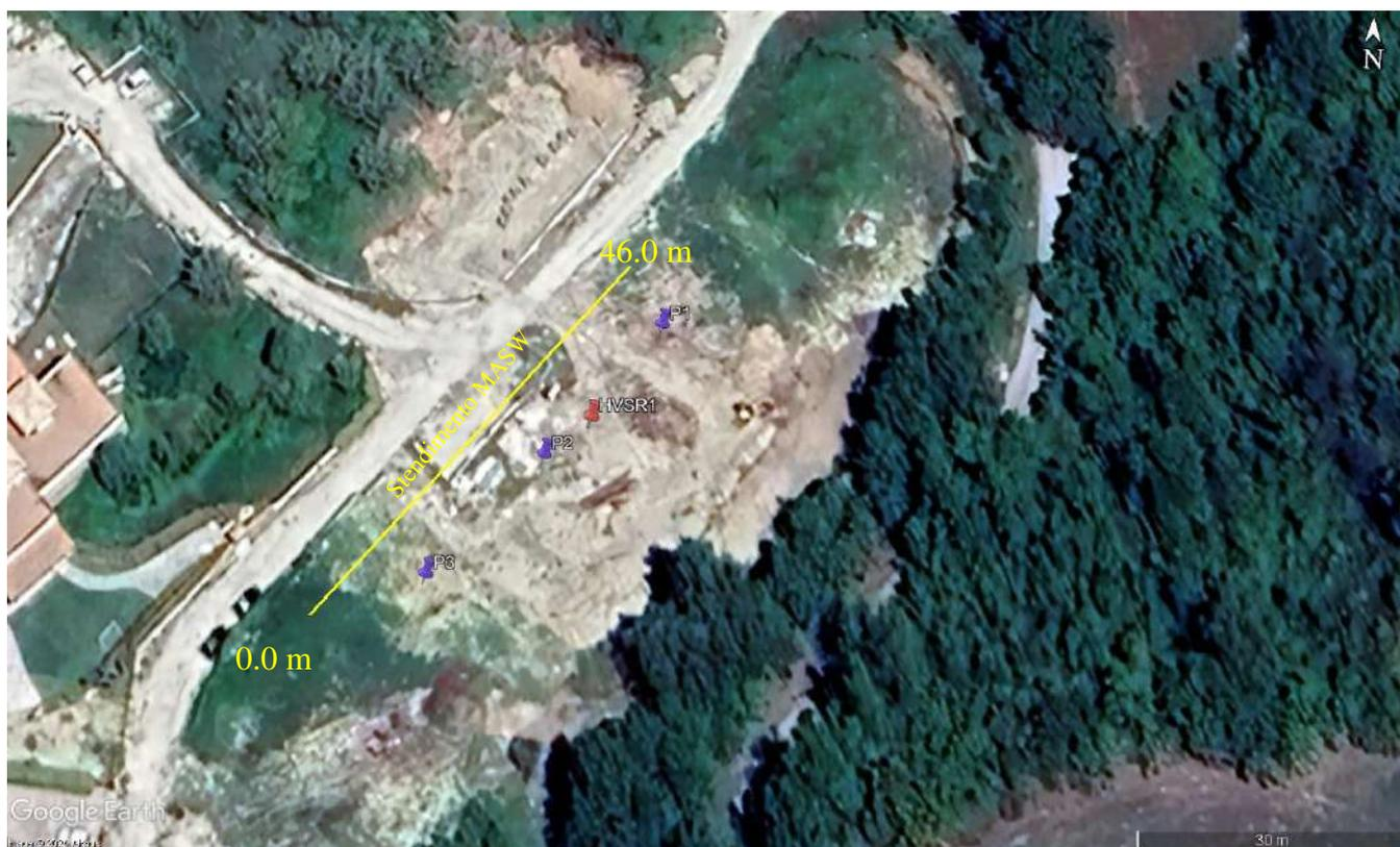
Foto 1: Foto satellitare reperita da Google Earth. In giallo lo stendimento di lunghezza 46.00 metri, in viola le prove penetrometriche e in rosso la registrazione dei microtremori.
