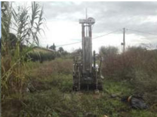
Strumento utilizzato... DPSH (Dinamic Probing Super Heavy)
