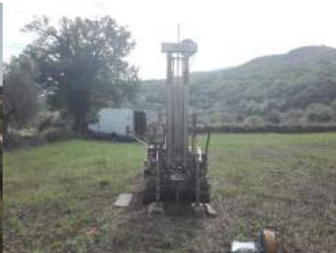
Strumento utilizzato... DPSH (Dinamic Probing Super Heavy)
