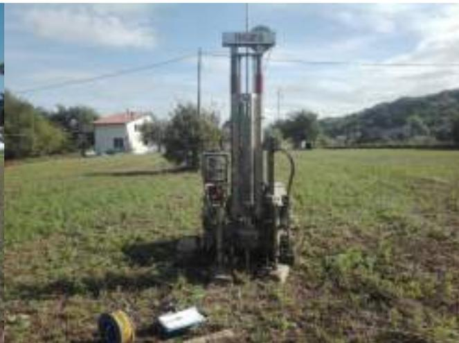
Strumento utilizzato... DPSH (Dinamic Probing Super Heavy)
