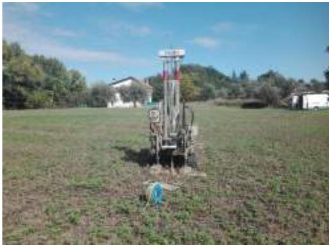
Strumento utilizzato... DPSH (Dinamic Probing Super Heavy)
