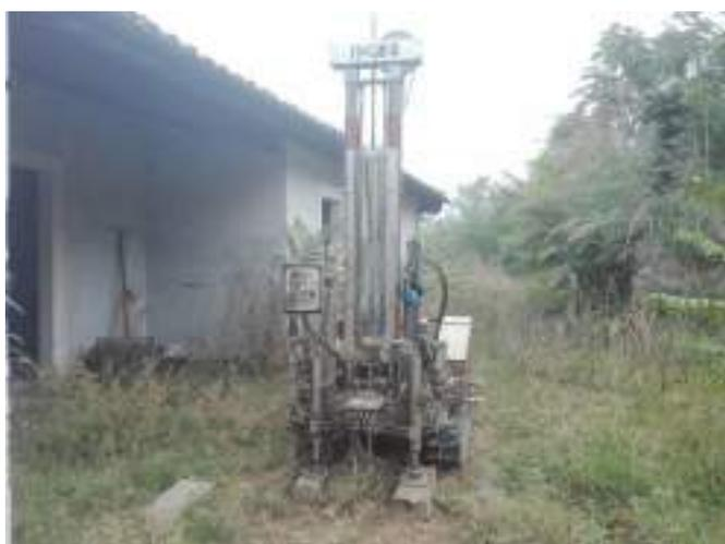
Strumento utilizzato... DPSH (Dinamic Probing Super Heavy)
