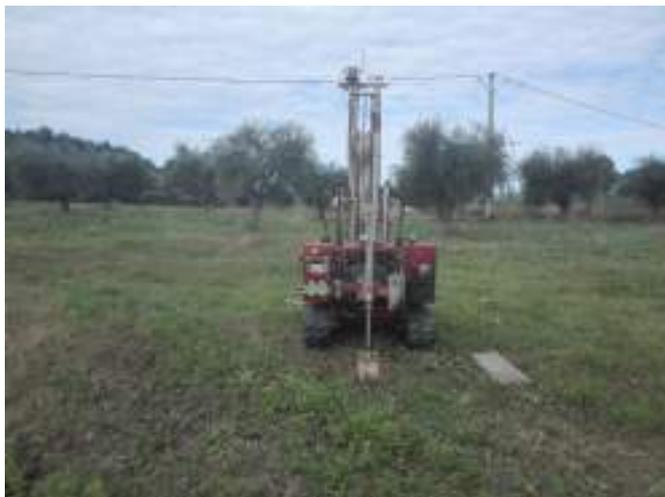
Strumento utilizzato... DPSH (Dinamic Probing Super Heavy)
