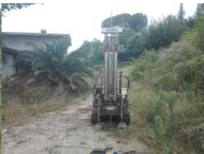
Strumento utilizzato... DPSH (Dinamic Probing Super Heavy)
