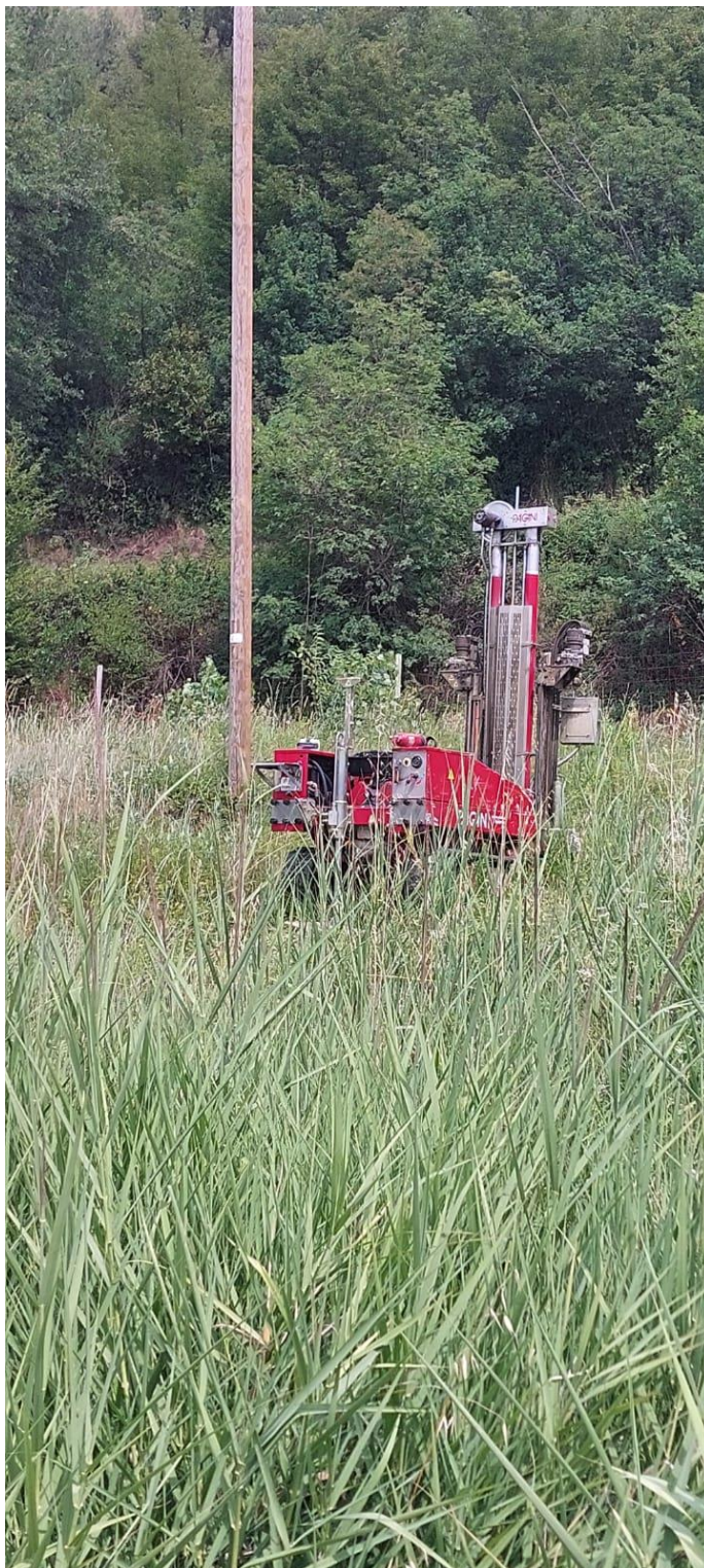
Foto 2: Penetrometrica superpesante effettuata con Pagani 63/200
