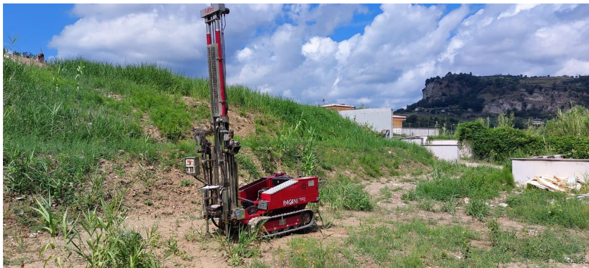
Foto 6: Penetrometrica superpesante effettuata con Pagani 63/200
