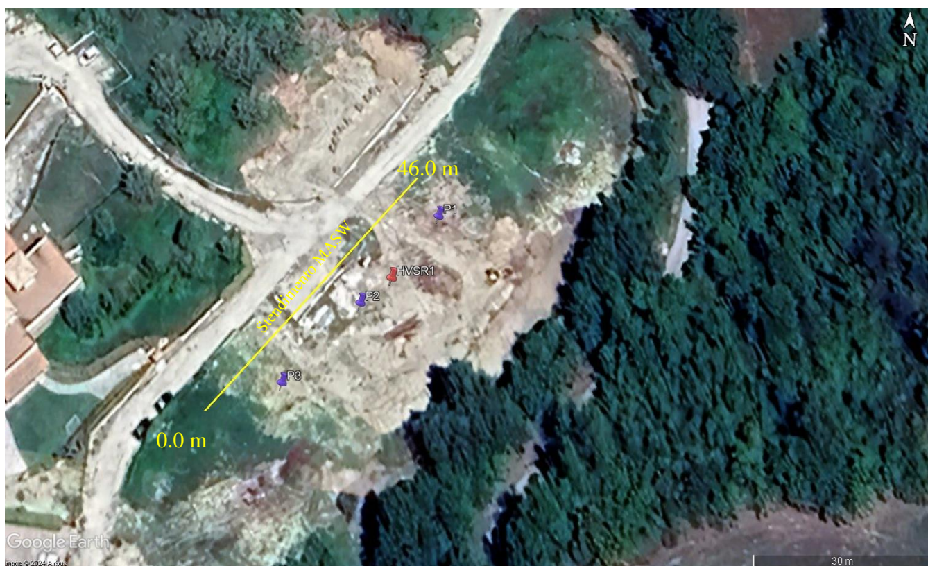
Foto 1: Foto satellitare reperita da Google Earth. In giallo lo stendimento di lunghezza 46.00 metri, in viola le prove penetrometriche e in rosso la registrazione dei microtrempi.
