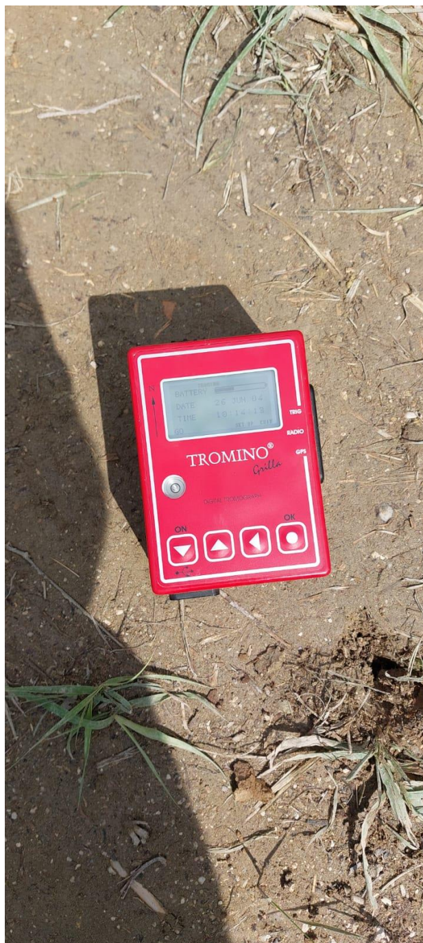
Figura 13 Tromografo in fase di registrazione (HVS-1)
