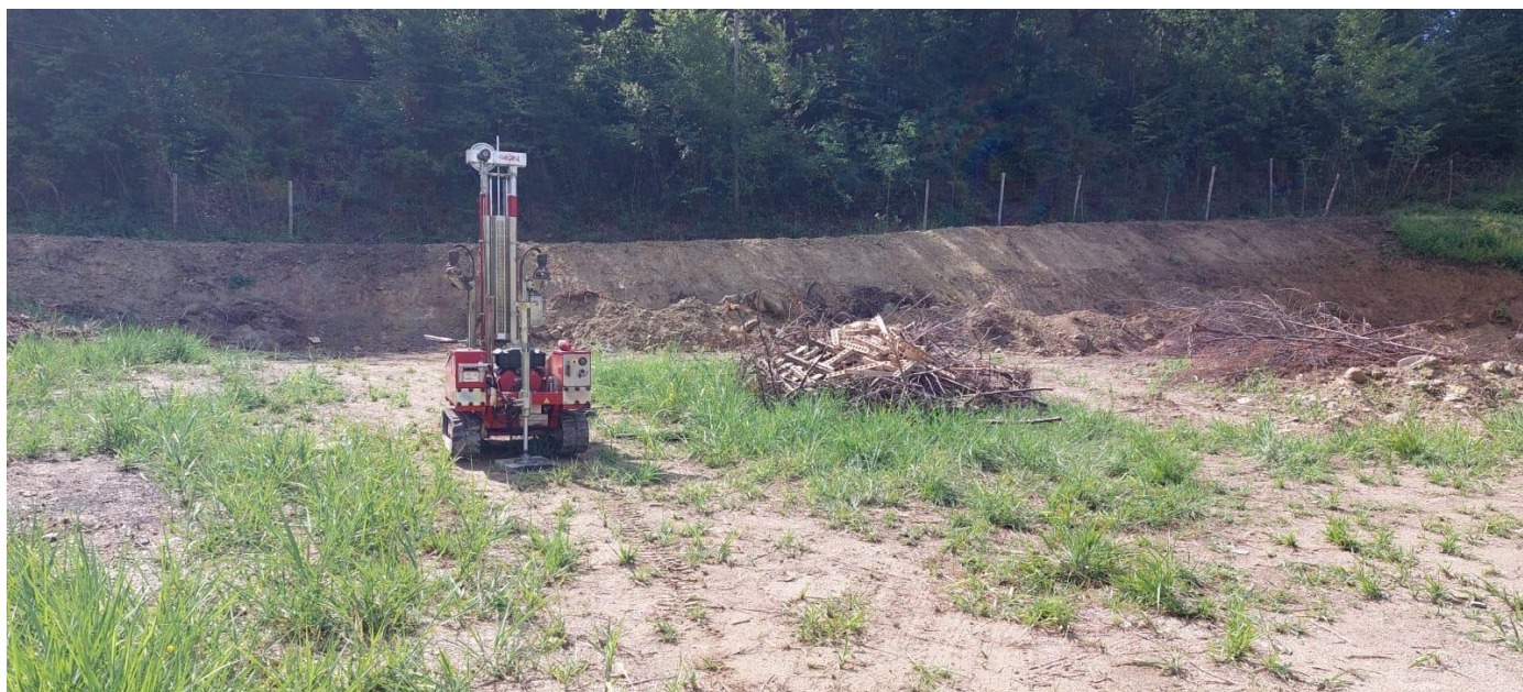
Foto 4: Penetrometrica superpesante effettuata con Pagani 63/200
