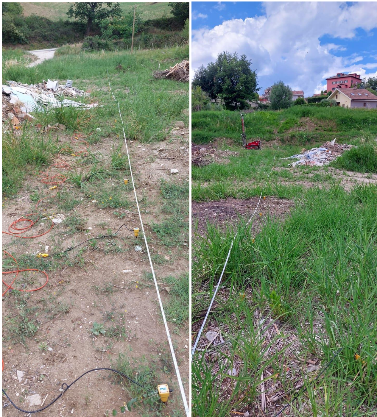
Foto 8: stendimento sismico per indagine tipo MASW.
