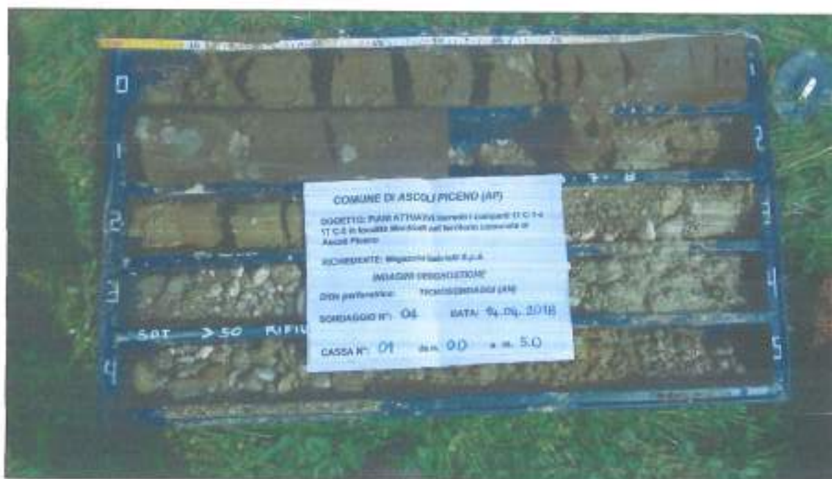
Foto nr. 5: Sondaggio SS4 a carotaggio continuo eseguito che intercetta il substrato - Cassetta catalogatrice 01 - da m. 0.00 a m. -5.00.
