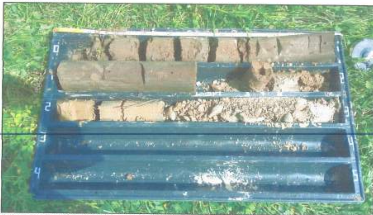
Foto nr. 8: Particolare della cassetta catalogica 01 del sondaggio SS4 in cui si nota l'esecuzione della prova penetrometrica dinamica in foro SPT1.
