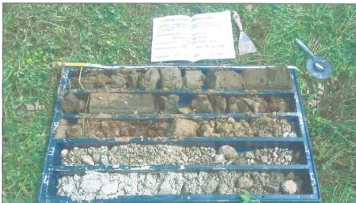
Foto nr. 3: Sondaggio SS3 a carotaggio continuo eseguito che intercetta il substrato - Cassetta catalogatrice 01 - da m. 0.00 a m. -5.00.
