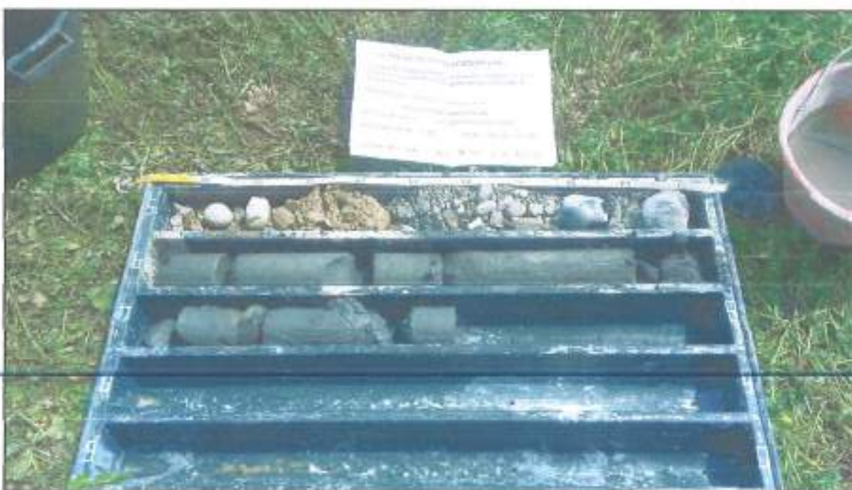
Foto nr. 4: Sondaggio SS3 a carotaggio continuo eseguito che intercetta il substrato - Cassetta catalogatrice 02 - da m. -5.00 a m. -10.00.
