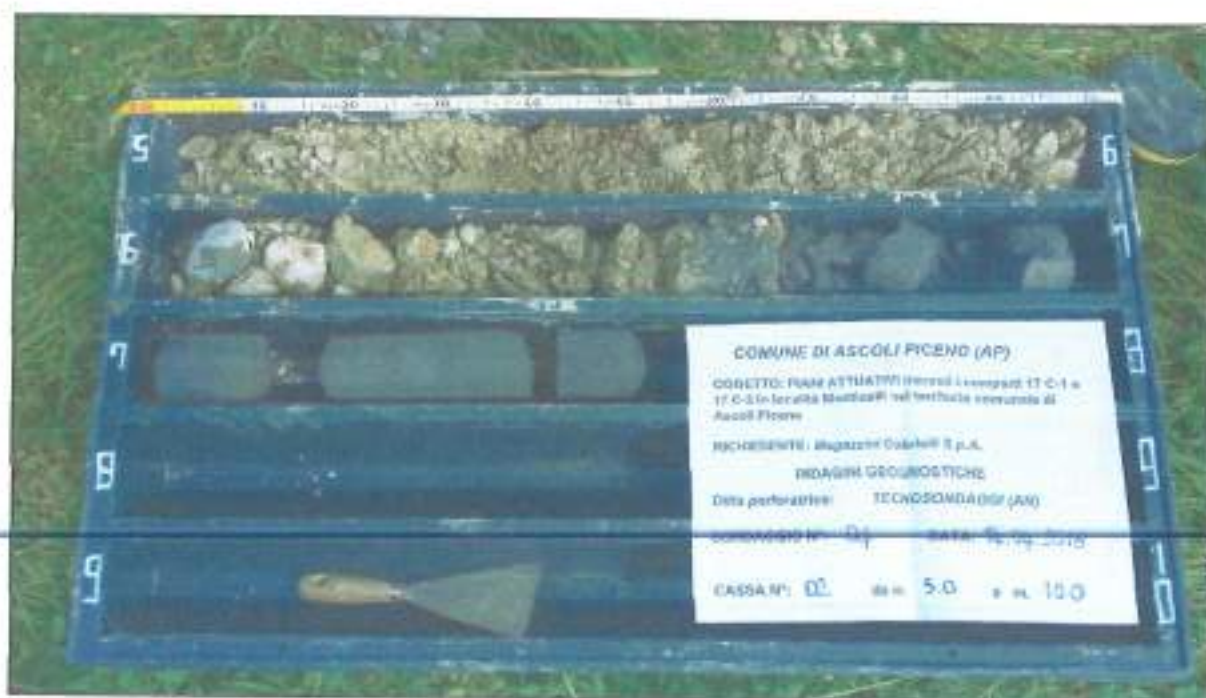
Foto nr. 6: Sondaggio SS4 a carotaggio continuo eseguito che intercetta il substrato - Cassetta catalogatrice 02 - da m. -5.00 a m. -10.00.
