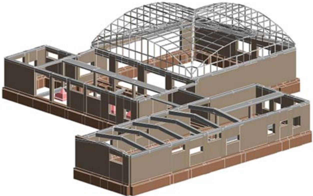
**Modello 3D** seconda vista della struttura in muratura
