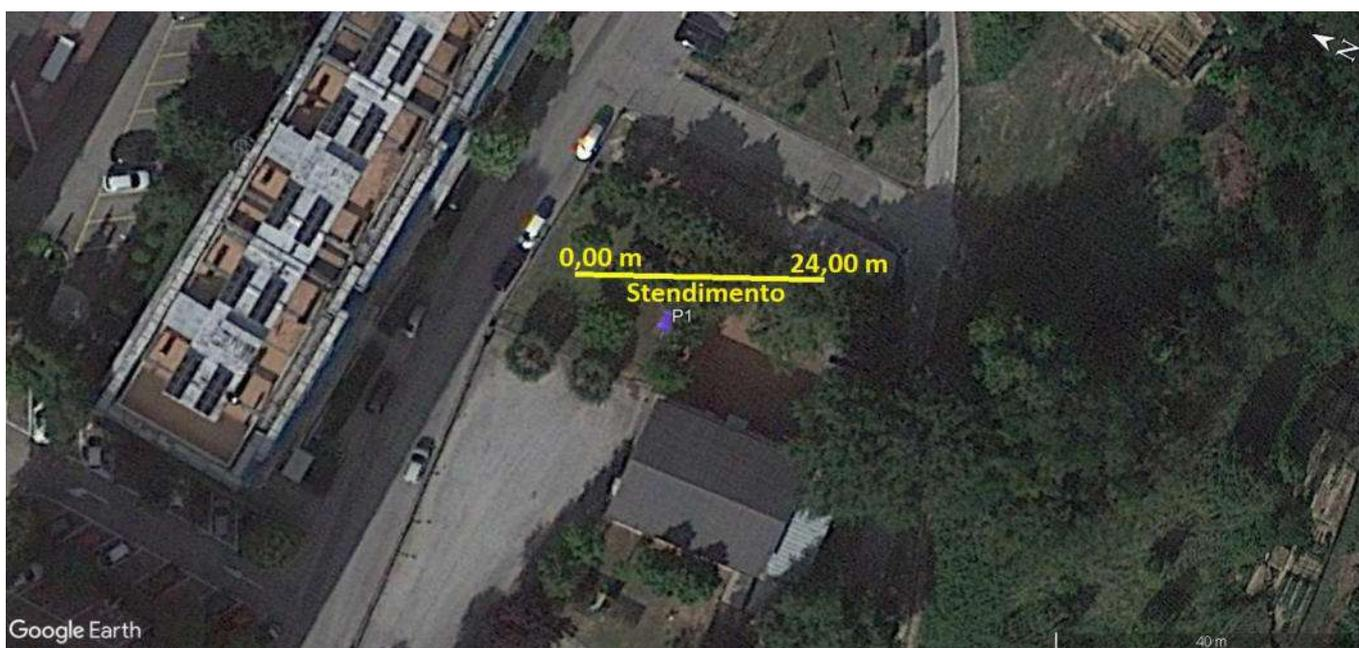
Foto 1: Foto satellitare reperita da Google Earth. In viola la prova penetrometrica, in giallo lo stendimento effettuato di lunghezza 24.00 metri.
