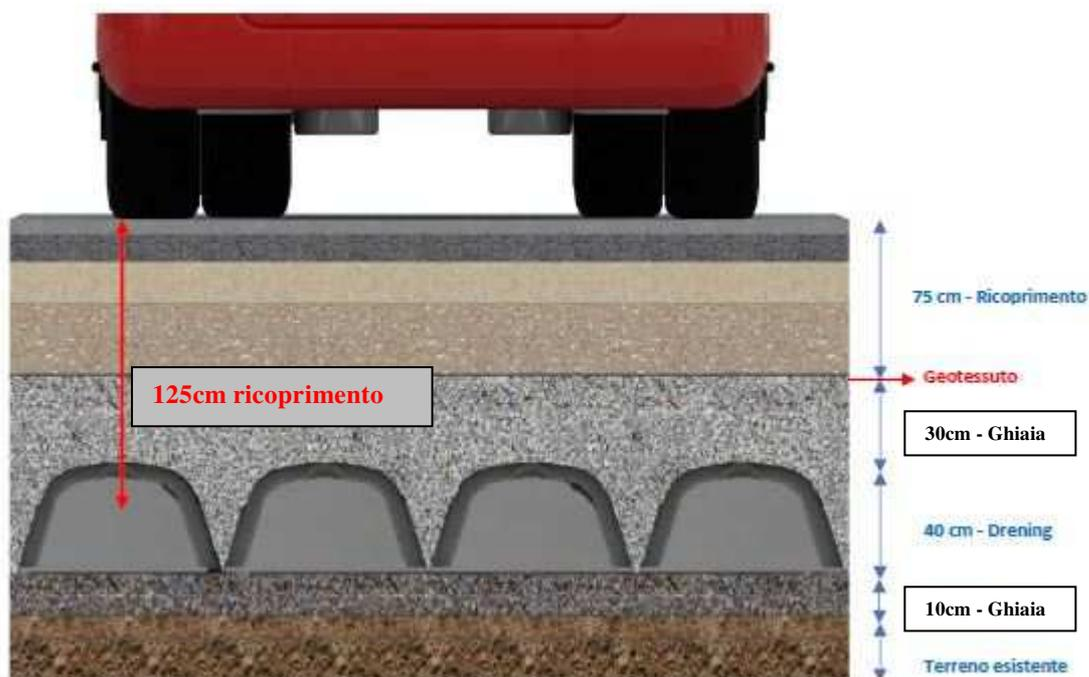
La geometria del sistema è quella indicata nella tavola inerente i sottoservizi e prevederà l'installazione degli elementi disperdenti al di sotto di parte degli stalli del parcheggio.
