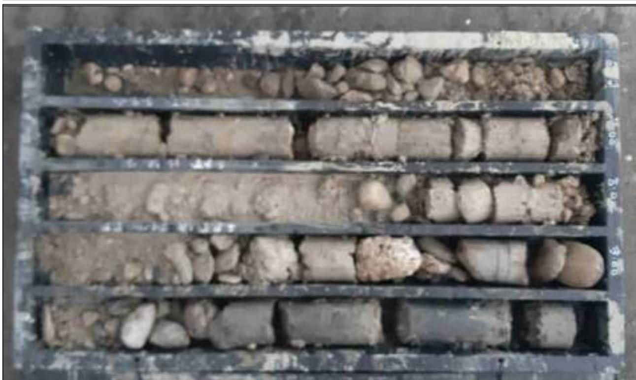
Foto 3: Stratigrafia sondaggio S1 da 5.0 a 10.0 ml.
