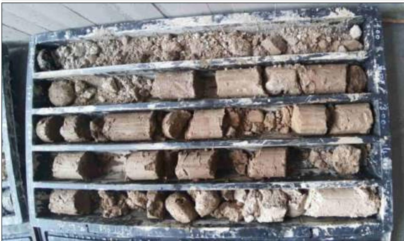
Foto 7: Stratigrafia sondaggio S2 da 5.0 a 10.0 ml.
