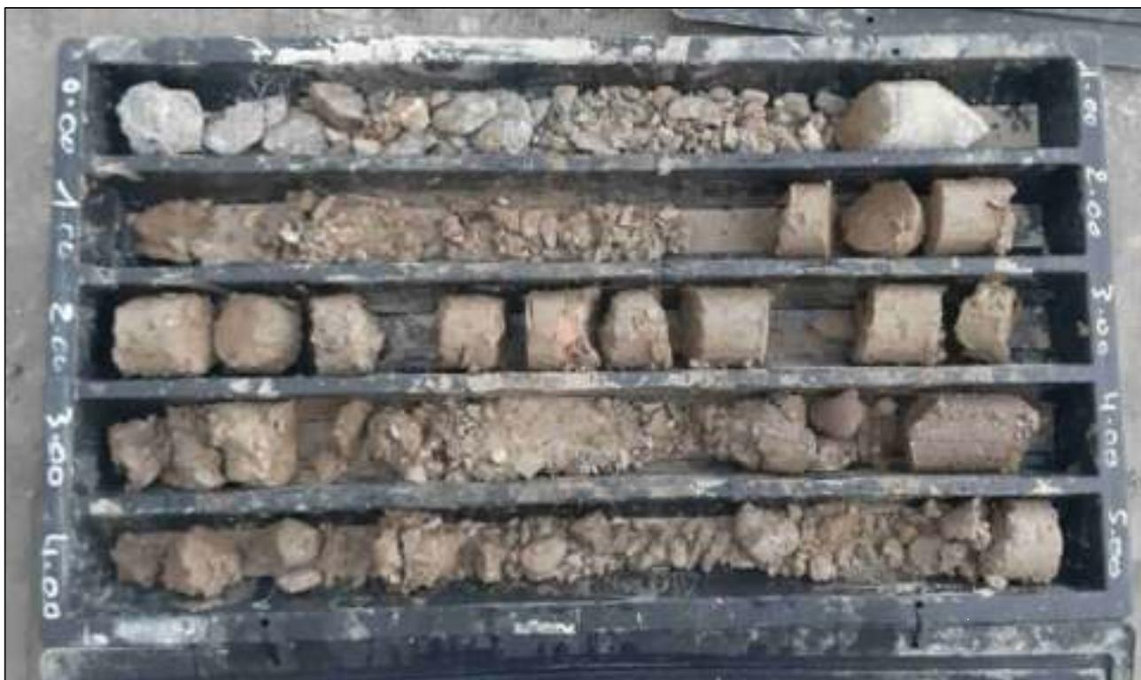
Foto 2: Stratigrafia sondaggio S1 da 0.0 a 5.0 ml.
