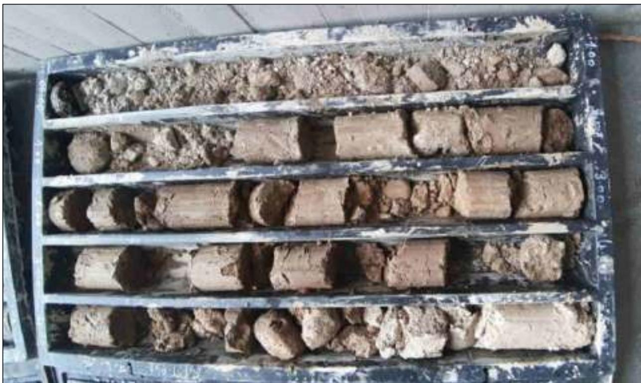
Foto 6: Stratigrafia sondaggio S2 da 0.0 a 5.0 ml..
