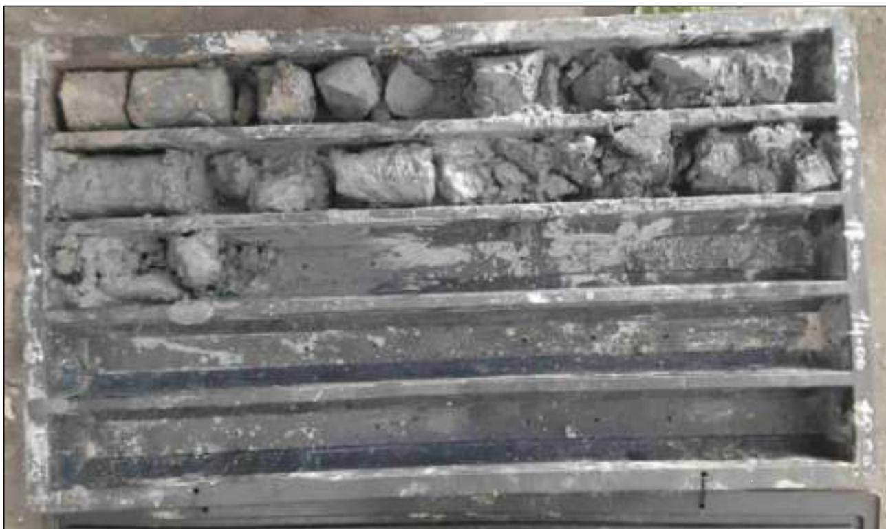
Foto 4: Stratigrafia sondaggio S1 da 10.0 a 12.0 ml.
