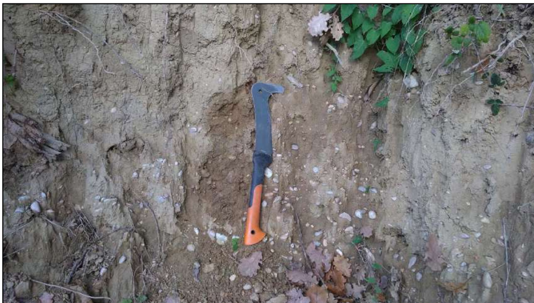
Foto 1 – Affioramento della porzione più superficiale delle Alluvioni Terrazzate del terzo ordine in corrispondenza di una piccola scarpata di valle dell'area oggetto di studio.
