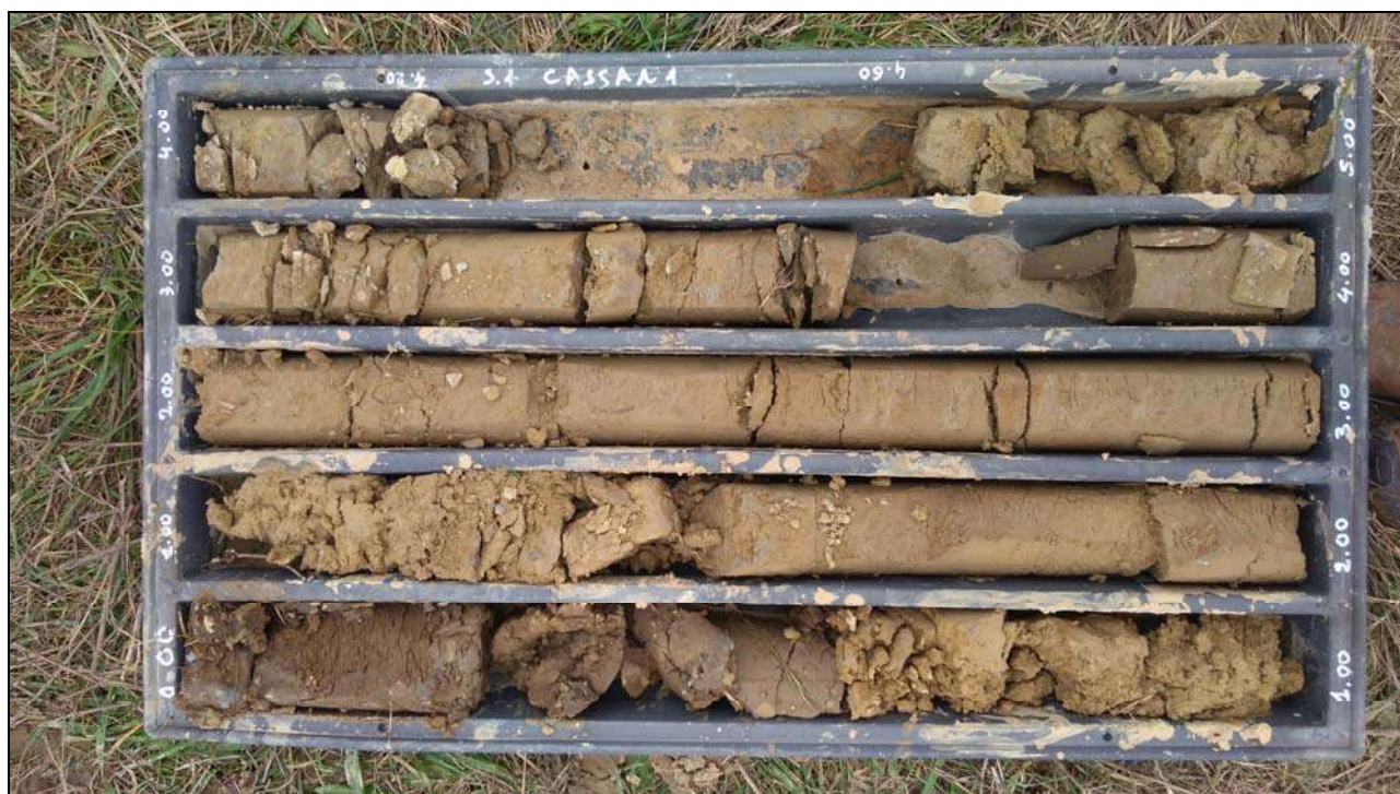
Foto 4 – Cassetta del sondaggio S1 da 0,0 a 5,0 m dal p.c.
