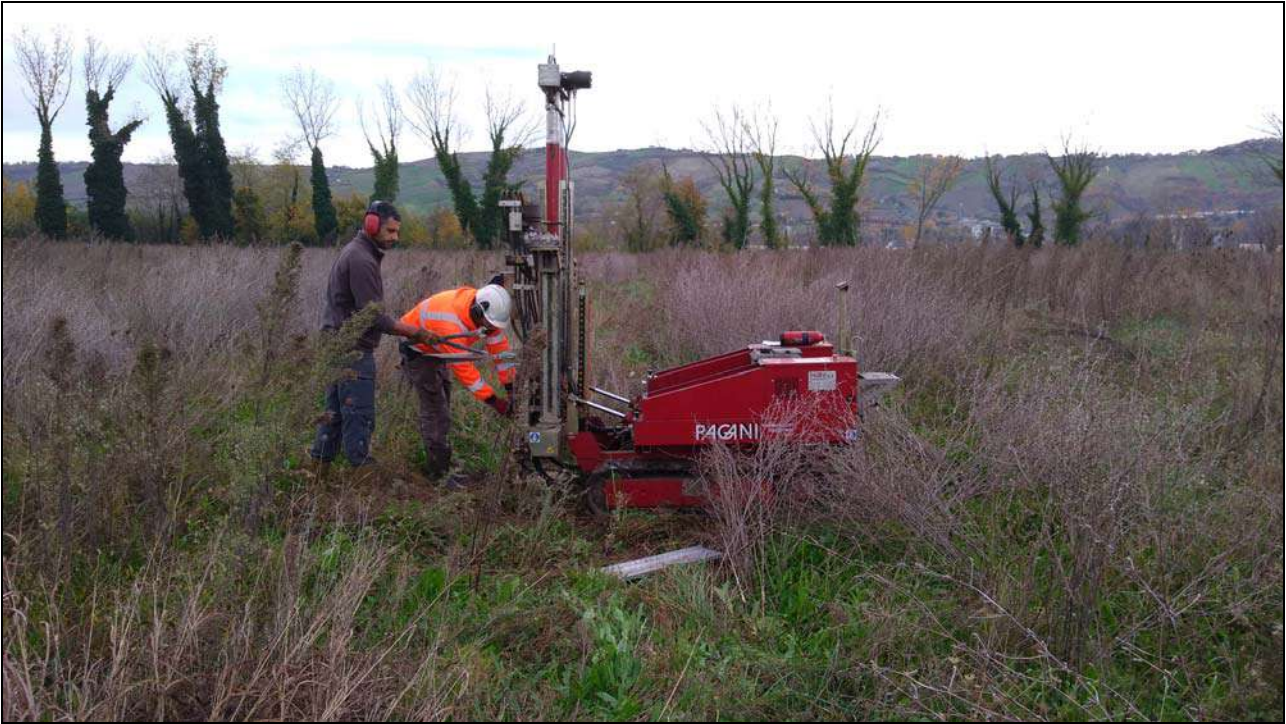
Foto 9 – Prova penetrometrica SCPT 01.
