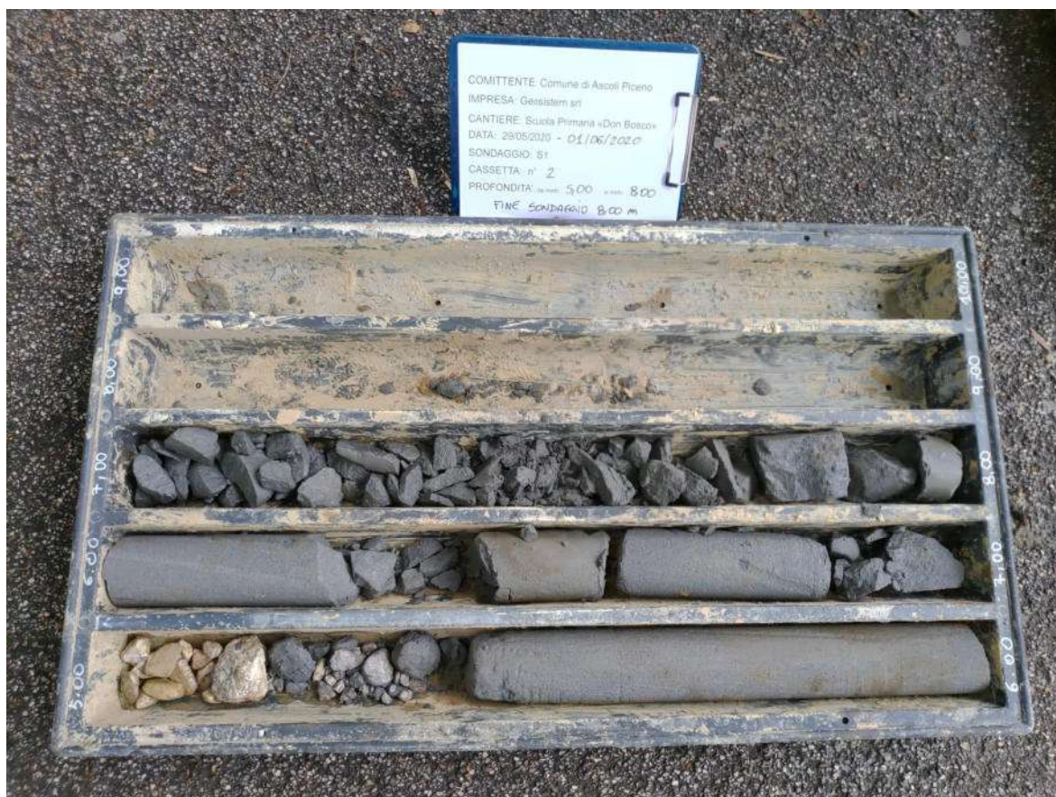
Foto 3 – Sondaggio S1 - cassetta n.2 da 5,00 m a 8,00 dal p.c.
