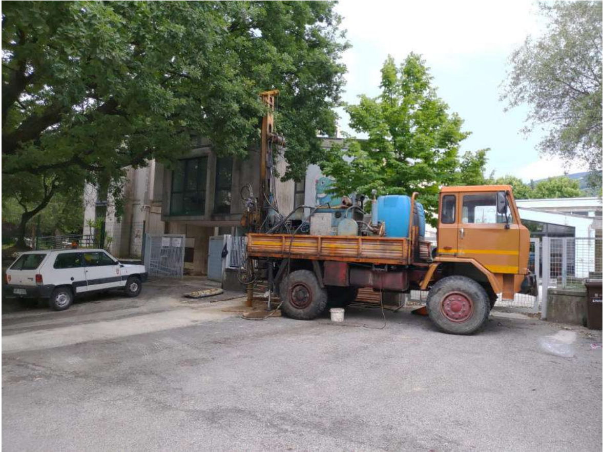
Foto 1 – Postazione sondaggio geognostico S1 a rotazione continua.
