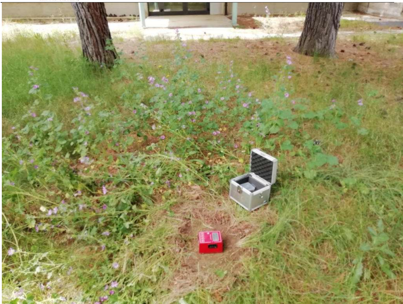
Foto 3:Foto tromografo in fase registrazione HVSRI.
