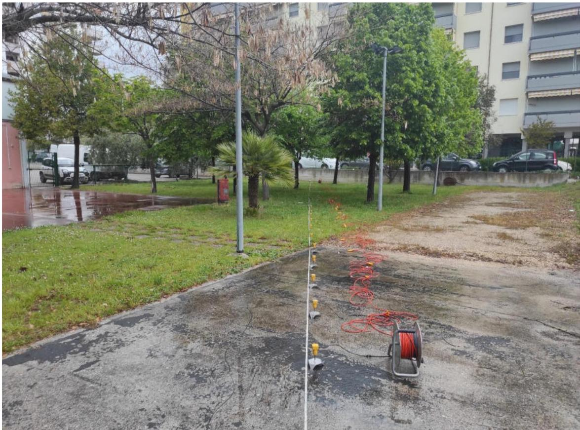
*Foto 4: stendimento sismico per indagine tipo MASW.*
