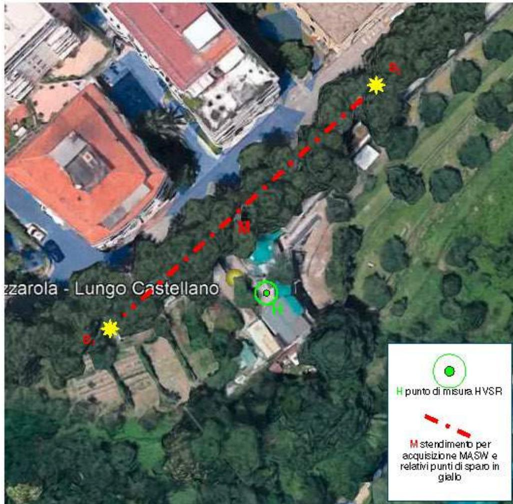
Figura 0.2 – PLANIMETRIA DI RIFERIMENTO da GoogleEarth (data acquisizione immagini 7/7/2021) con l'ubicazione delle indagini sismiche.
