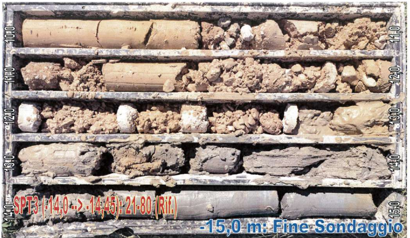
Cassette Catalogatrici sondaggio S1 – Profondità: da -0,0 metri a -15,0 metri
