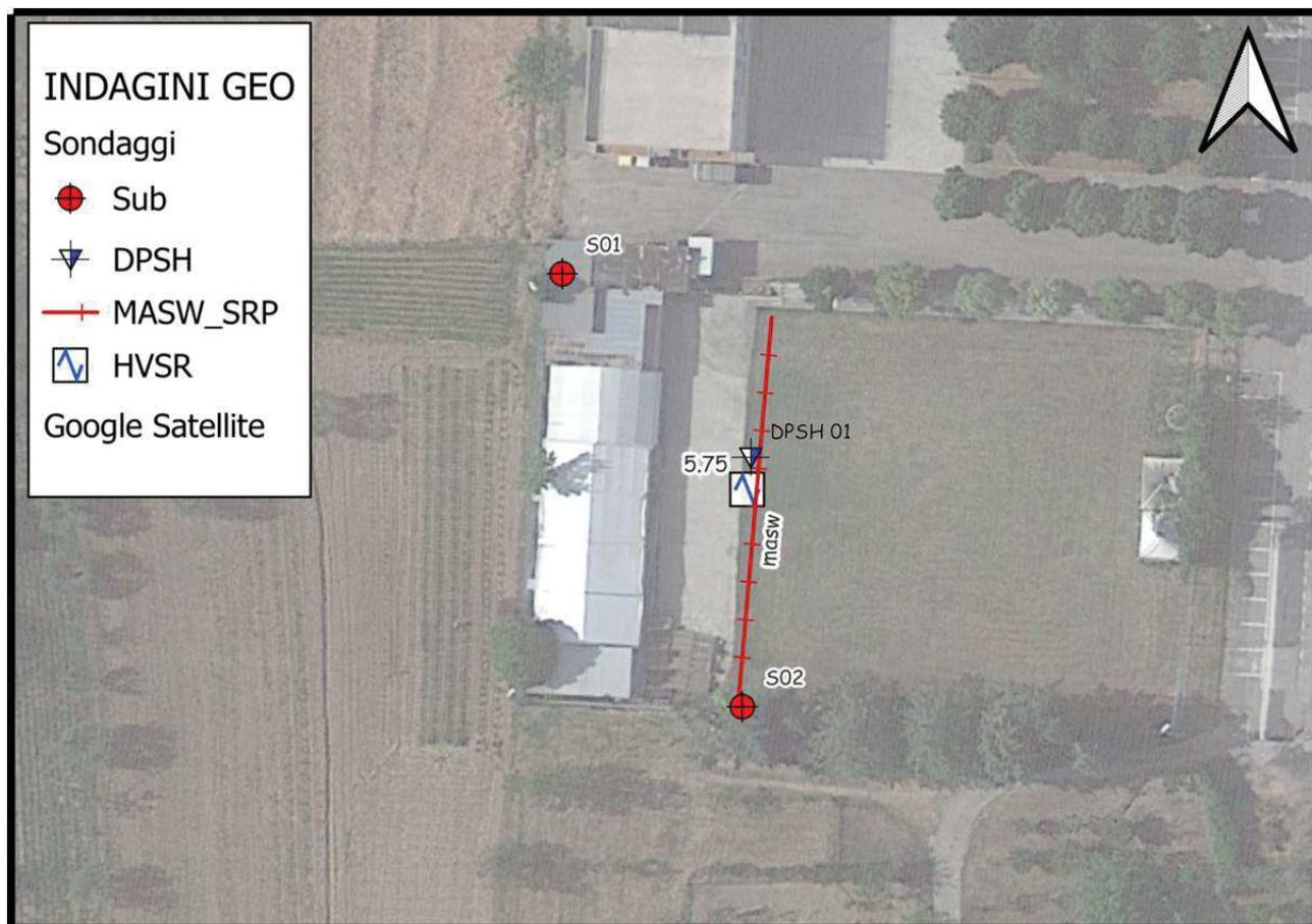
L'indagine sismica mostra una sequenza sismo-stratigrafica caratterizzata da un gradiente di Vs crescente con la profondità, con valori di Vs molto bassi che passano da 150 m/s in superficie, per il primo metro, per poi aumentare fino a 300 m/s, fino alla profondità di 4 metri dove i valori di Vs >650 m/sec (basamento della Laga alterato/ghiaia addensata); a partire da 6.60 mt di profondità il valore del Vs > 800 m/sec (bedrock sismico inalterato).
