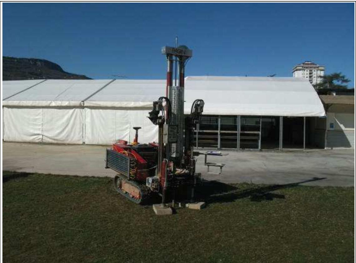
**PROVA PENETROMETRICA DINAMICA DPSH**
