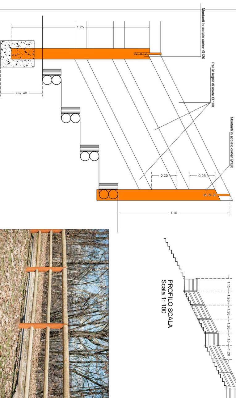
PARTICOLARE PARAPETTO ACCIAIO E LEGNO - Scala 1 : 10
