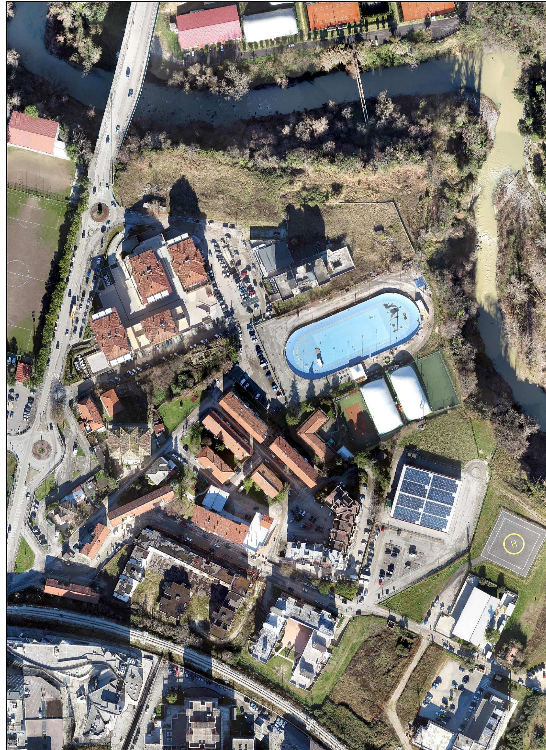
ORTOFOTO DA RILIEVO FOTOGRAMMETRICO TRAMITE DRONE "eBee" AD ALA FISSA ESEGUITO IN DATA 14/01/2017 ORE 11.50 RISOLUZIONE 4 CM/PIXEL (DITTA GEOSERVICE SRL, FERMO)
