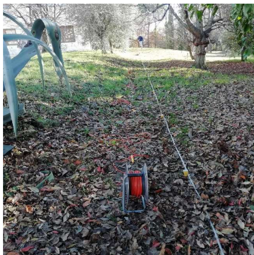
Foto 2:Foto stendimento sismica attiva lunghezza 46 m
