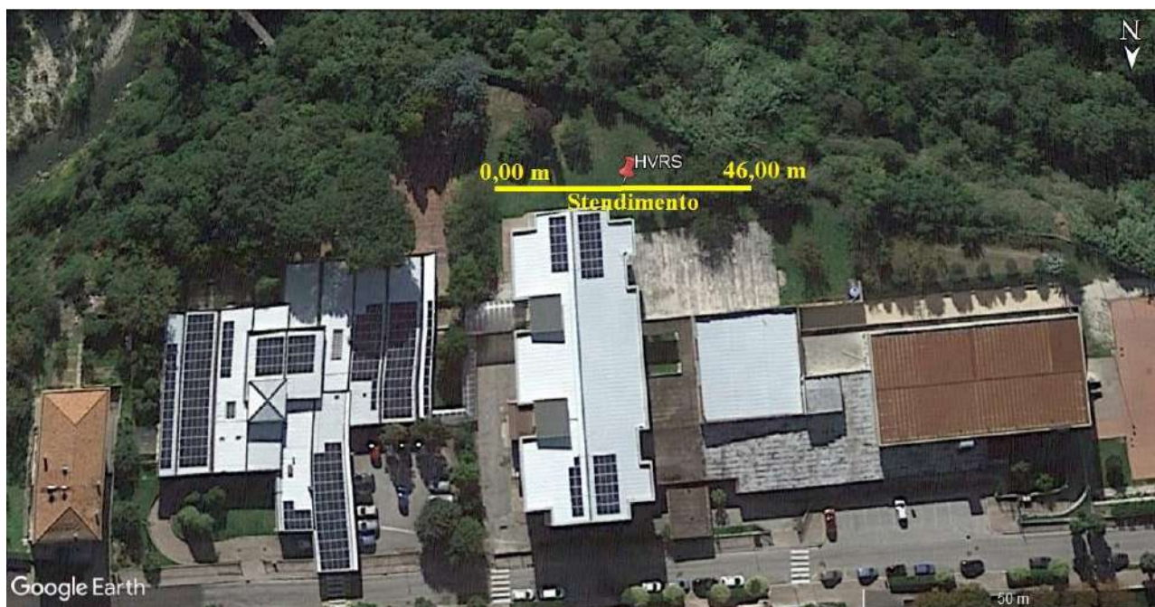
Foto 1: Foto satellitare reperita da Google earth. In giallo lo stendimento effettuato di lunghezza 46,00 m e in rosso l'ubicazione della registrazione dei microtremori.
