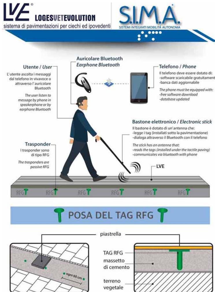
Schema di funzionamento del sistema LOGES VET Evolution
