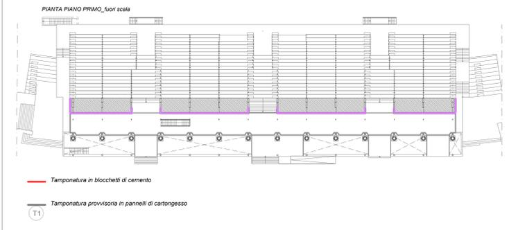
PIANTA SPALTI - STATO DI PROGETTO
