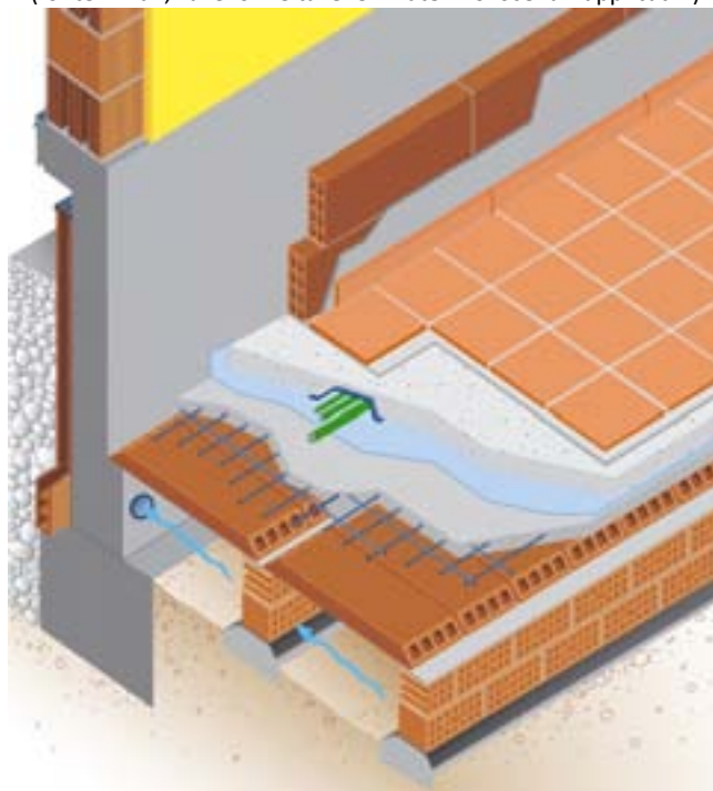
Gattaiolato in tavelloni su muricci in laterizio (fonte: Andil, Tavelloni e tavelle in laterizio: scenari applicativi)
