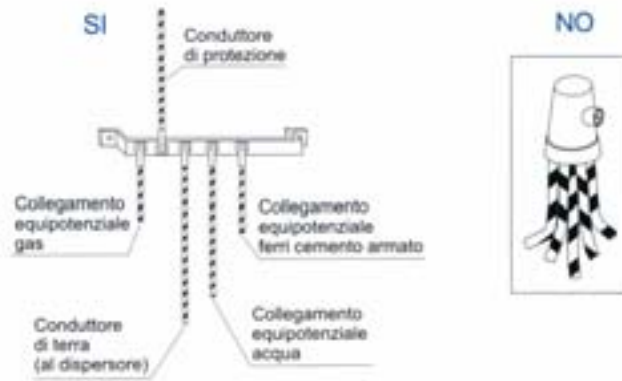
Figura: collettore di terra
