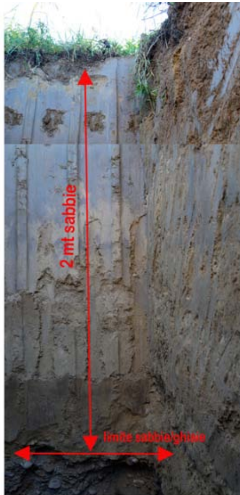
Figura 14: il saggio S2 ha evidenziato una copertura sabbiosa di 2 mt sopra il limite con le ghiaie.
