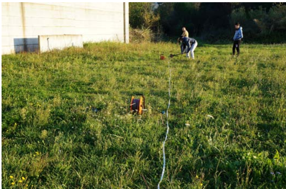
Figura 15: esecuzione prova sismica
