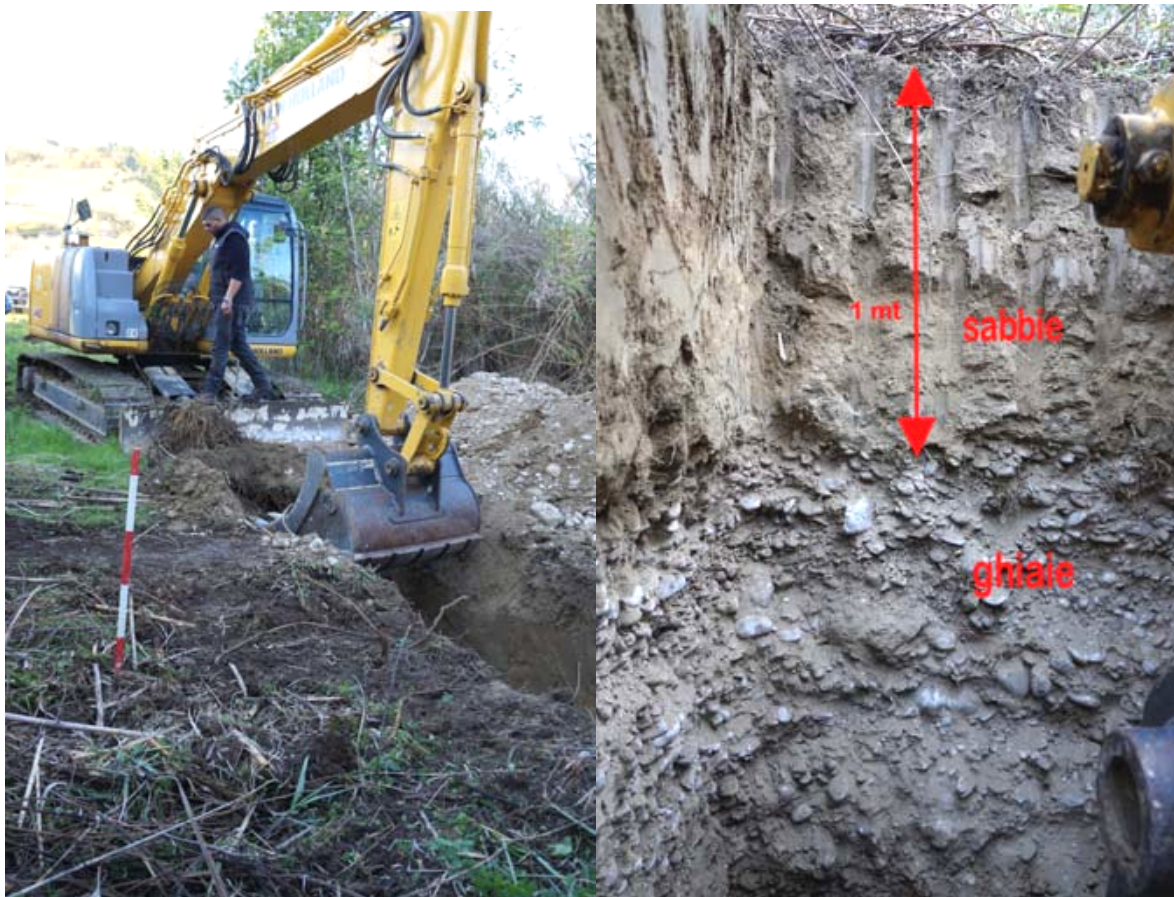
Figura 11-12: esecuzione saggio S1 e sezione stratigrafica esposta, 1 mt di sabbie al di sopra di ghiaie embriciate e ben classate, - 5,0 mt fine saggio ( ghiaie in continuità stratigrafica)
