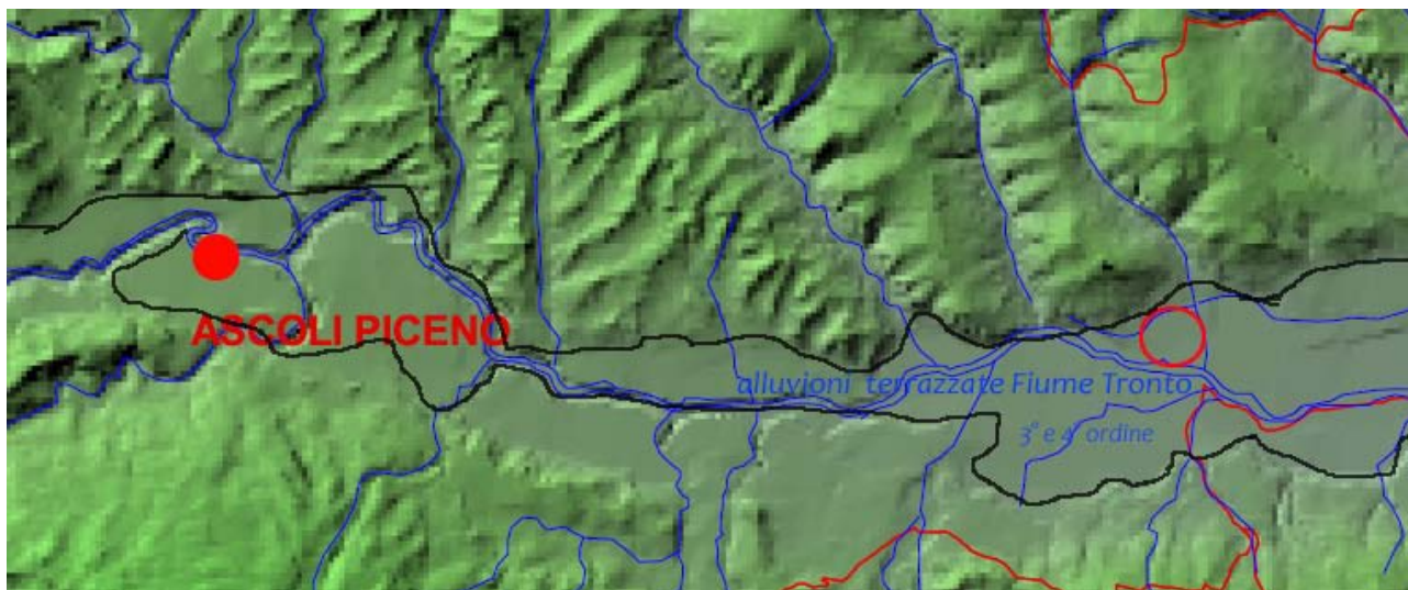
Figura 21 : modello 3D della vallata del Tronto, la copertura detritica alluvionale, classata nei millenni dai corsi d'acqua (soprattutto il Fiume Tronto) crea l'orizzontalità morfologica evidente su cui poggia Ascoli Piceno ( e il sedime).
