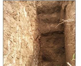
Foto n°7: La foto mostra lo scavo del saggio esplorativo Se2, anche qui si rileva la presenza del paramento murario, dell'appoggio costituito da materiale eterogeneo e le sabbie limose che costituiscono il substrato geologico.
