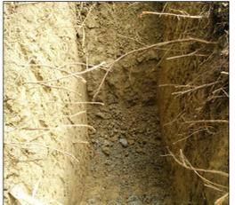
Foto n°9: La foto mostra lo scavo del saggio esplorativo Se3, dove è stata riscontrata la presenza del colluvio costituito da sabbie limose poggianti sulla formazione arenaceo-marmosa.
