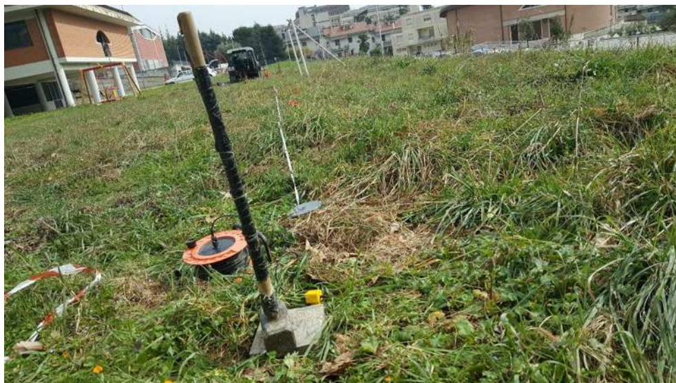
Foto 2 – vista dello stendimento MASW realizzato dallo SPARO N.2 (posizione in primo piano).
