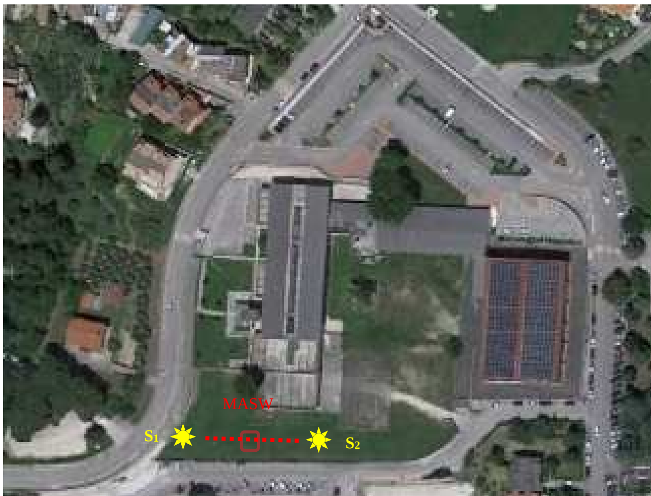
Figura 2 - ubicazione dell'indagine MASW : posizione (■) del centro dello stendimento e dei relativi spari (★).
