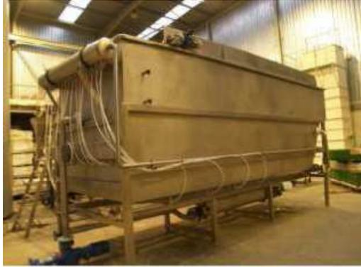
Esempio (a solo fine esplicativo) di un sistema a decantazione/flottazione DAF
